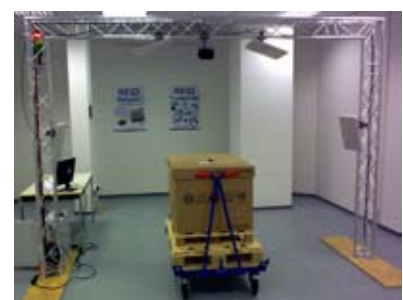
RFID-Gate mit Richtungsradar und Signallampe
