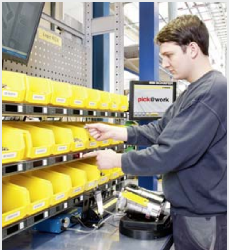
Lichtgesteuertes Montagesystem führt den Mitarbeiter Schritt für Schritt durch den Arbeitsprozess.
