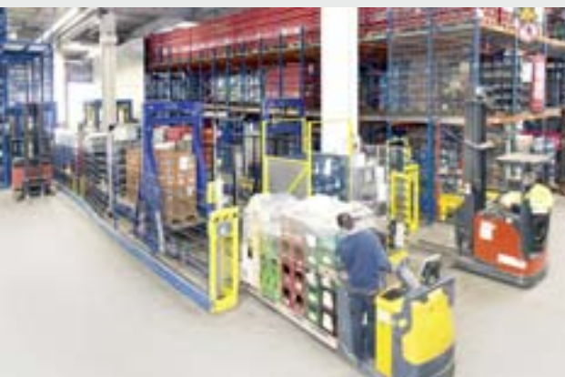
Die kommissionierten Auftragspaletten werden über 2 bodenebene Doppel-Paletten-Aufgabestationen an die Fördertechnik übergeben und in den automatisierten Prozess des 2-stufigen Versandpuffers eingeschleust.
