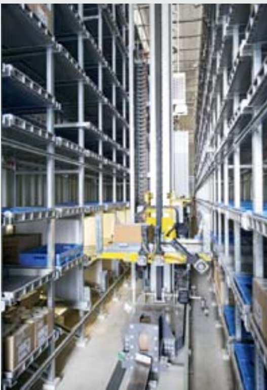
An den Übergabepunkten übernehmen die beiden RBG des Typs SMC die Trays und verteilen sie nach Vorgabe der Logistiksoftware WAMAS auf die Stellplätze.
