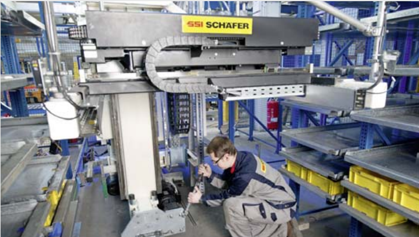
Bei der Montage wurden die RBG zunächst mit eigens konstruierten neuen Lastaufnahmemitteln ausgestattet, die einen Tablargreifer nebst Vershub- und Ziehkette bieten.
