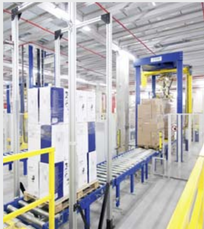
Vereinnehmung, IT-Erfassung, Konturen- und Gewichtskontrolle sowie Transportsicherung der Paletten.
