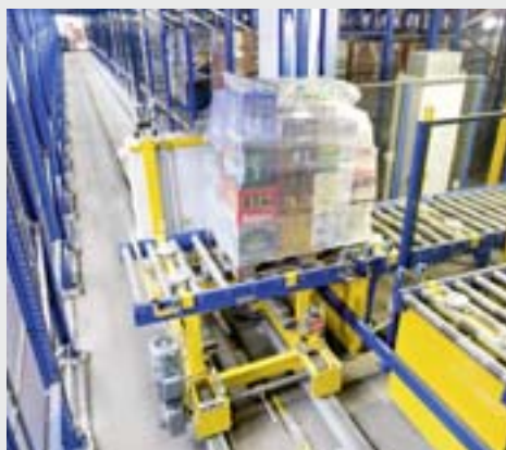
Vom Übergabepunkt des Senkrechtförderers übernimmt ein Verschiebewagen die Paletten und befüllt den Auftragspuffer.
