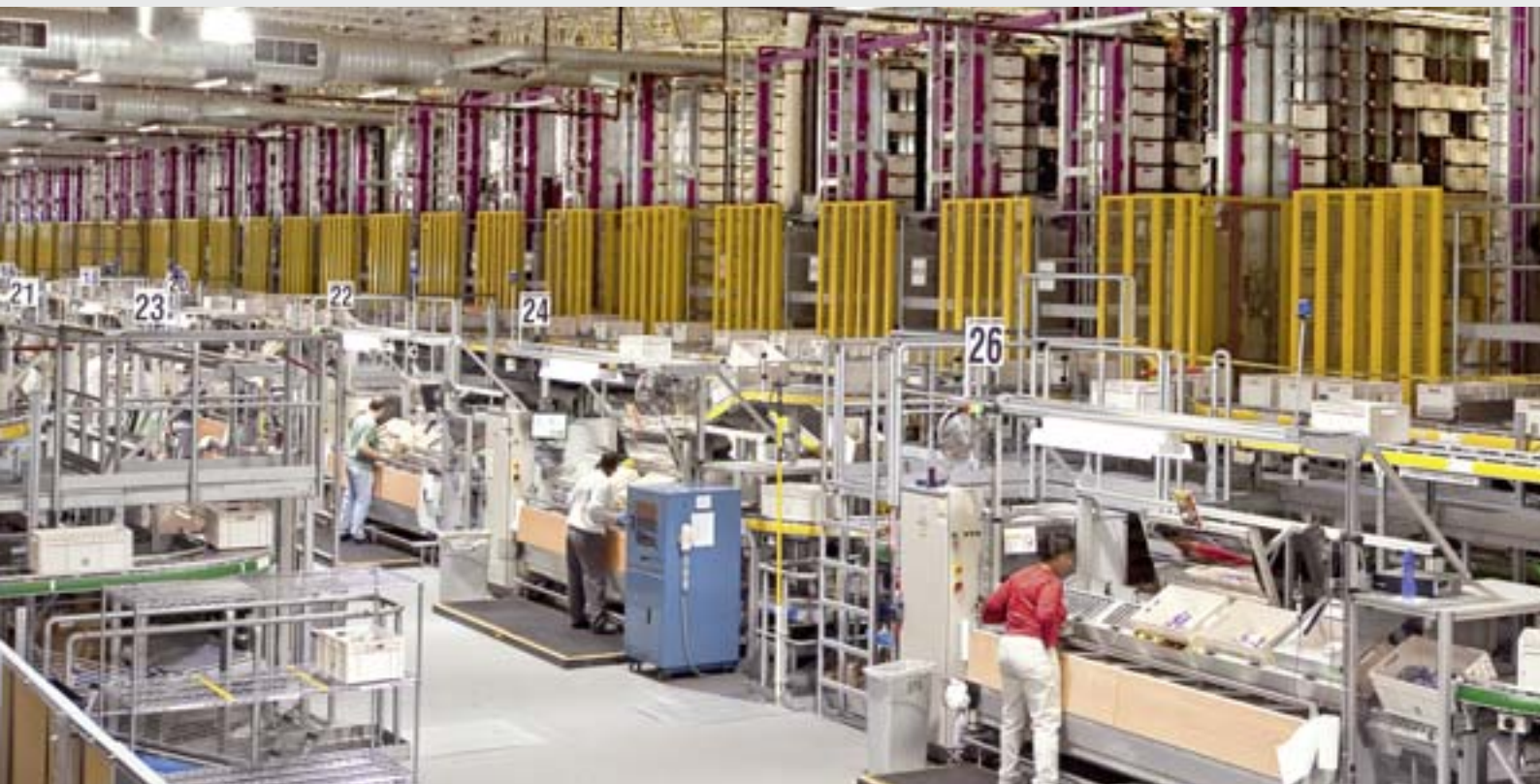
124 Schärer Carousel Systeme (SCS) mit den angebundenen Kommissionierarbeitsplätzen.
