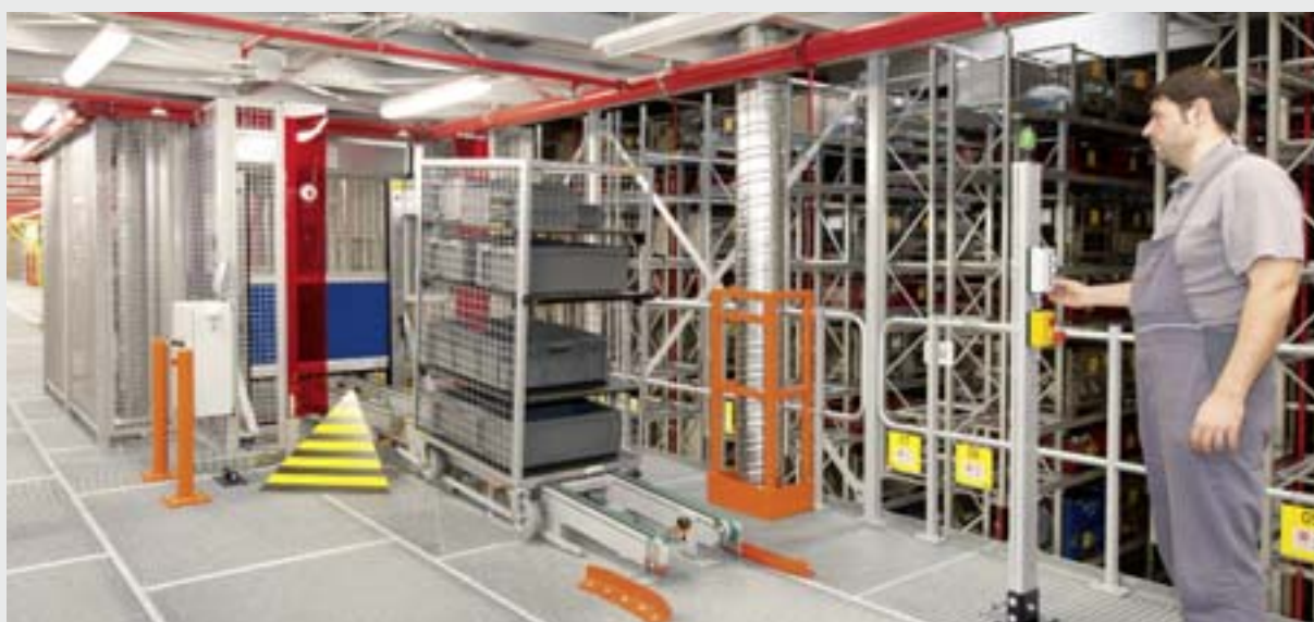
Die Mitarbeiter und Mitarbeiterinnen führen die Rollwagen an eine Übergabestation und wählen über Knopfschalter die gewünschte Bühnenebene.
