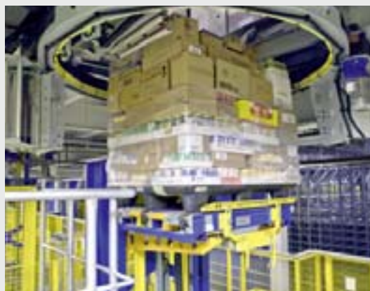
Die gefüllten Paletten werden auf die Warenausgangsebene abgesenkt und automatisch von einem integrierten Folien-Stretcher umwickelt.
