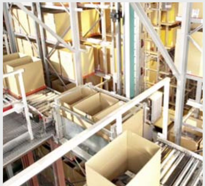
3-fach tiefe Lagerung von Kartons auf Tablaren
