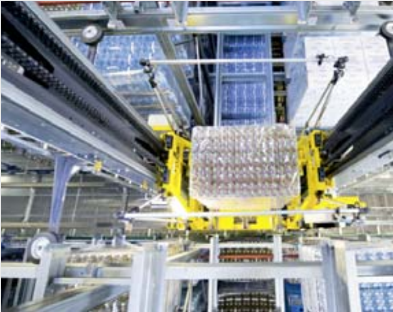
Wenn das Schäfer Lift&Run-Lagergerät vor dem zugewiesenen Regalkanal hält, hebt der Orbiter die Palette leicht an und transportiert sie in die Tiefe des Kanals.
