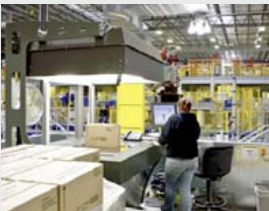
Bei der Warenannahme erfolgt zunächst ein Teach-in-Prozess für die IT-Stammdatenerfassung.
