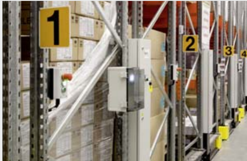
Durch die Wahl einer einfachtiefen Lagerung der Paletten wird ein 100 % flexibler Zugriff auf alle Waren garantiert.
