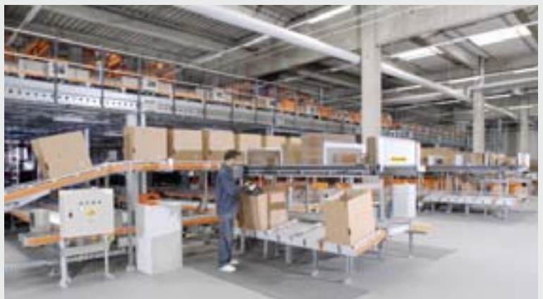
An den Kommissionierplätzen können bei Bedarf mehrere Aufträge parallel gepickt werden.
