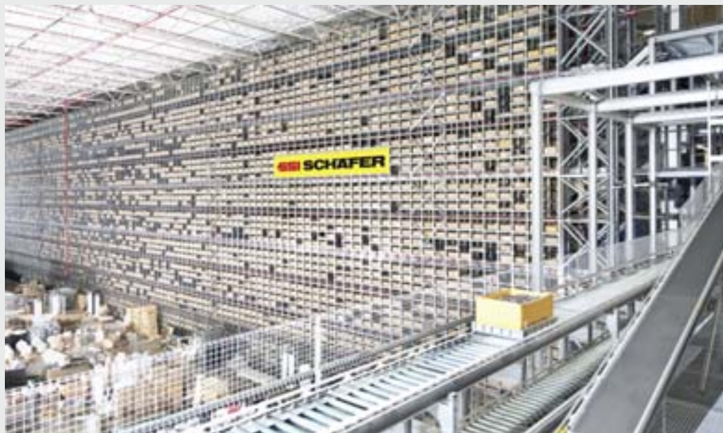
Im Shuttle-Lager steuert ein Shuttle bis zu 200 gelagerte Artikelkartons pro Stunde aus.
