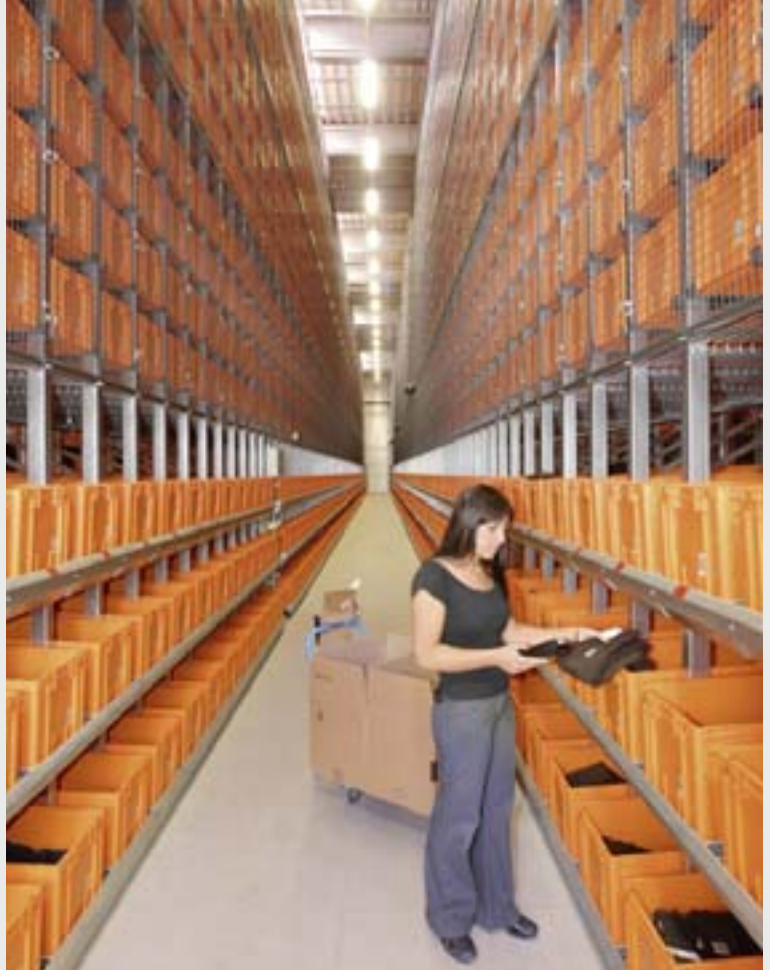
In den vier Gassen für die teilautomatisierte Kommissionierung bewegen sich die Mitarbeiter mit Rollwagen durch das Lager.
