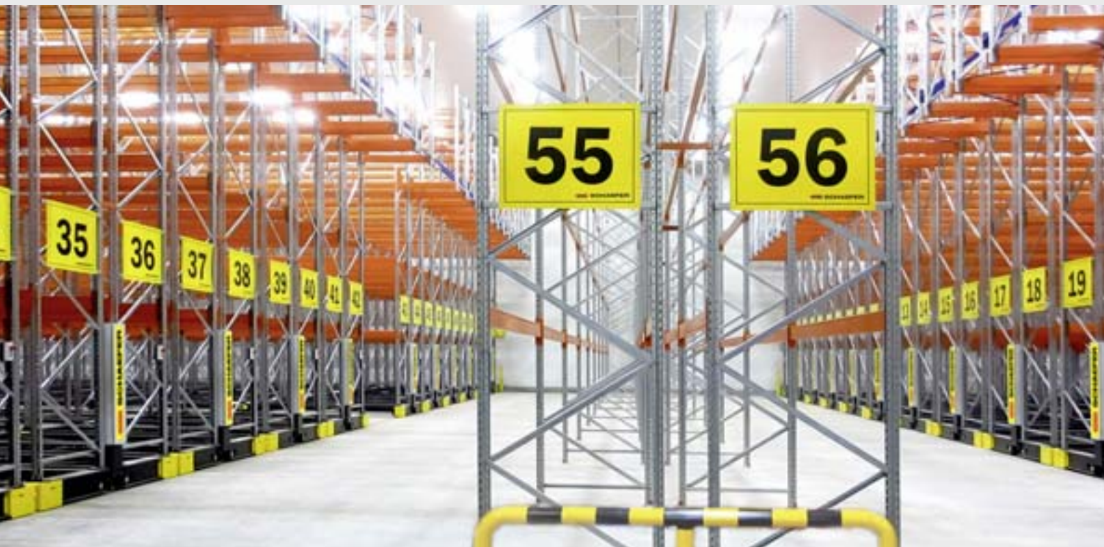
Das Verschieberegal bietet Platz für 14.500 Paletten bzw. für 13.000 Tonnen Ware.
