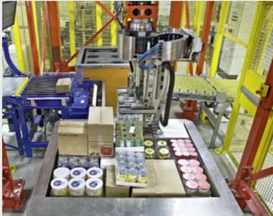
Das SCP-System ist auf einen Durchsatz von bis zu 74 Paletten pro Stunde mit 5.350 Cases ausgelegt.
