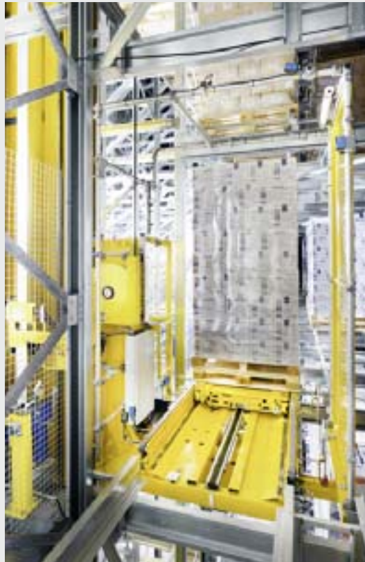
Der Lebensmittelhersteller Mydibel entschied sich bei der Konzeption seines neuen Tiefkühlagers für ein automatisches Kanallager mit Shuttle-Technik.
