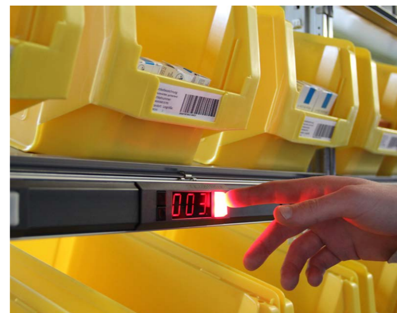
Auch die Kommissioniertechnologie Pick-by-Light (SSI Schäfer) kann im LernLager demonstriert und angewendet werden
