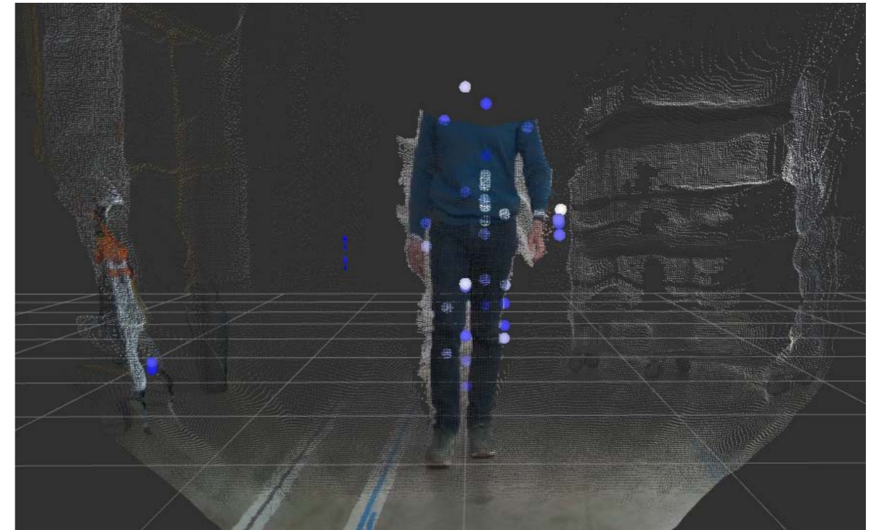
Ergebnisse einer Sensorfusion von Stereokamera und Radarsensor im Anwendungsfall der Produktionslogistik
